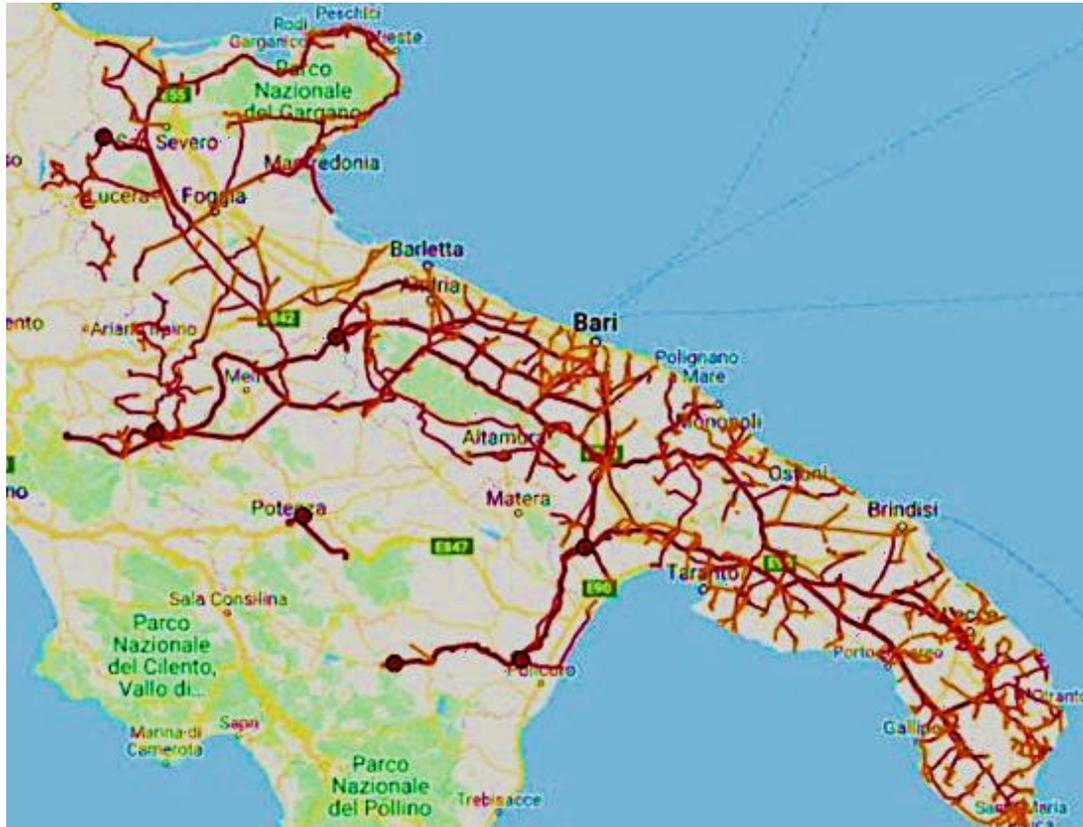
AQP gestisce un sistema di approvvigionamento che si struttura in sei schemi idrici interconnessi.
