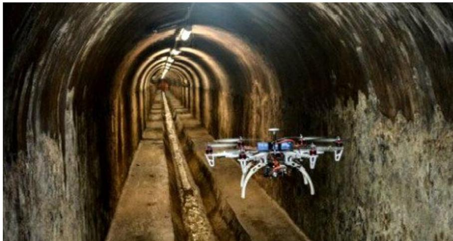
*Figura 7 - Drone per le ispezioni in galleria fognaria*
