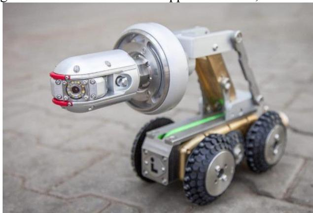
Figura 5 - Camera su ruote per video ispezioni fognaria
