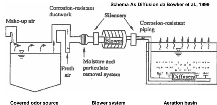
Lo schema mostra l'adozione in piena e vasta scala del sistema «As Diffusion» che comporta il risparmio di un'intera sezione di trattamento odori dedicata, sia da un punto di vista costruttivo che da un punto di vista della gestione dell'impianto stesso.
